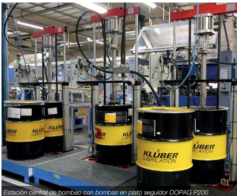
Estación central de bombeo con bombas en plato seguidor DOPAG P200
