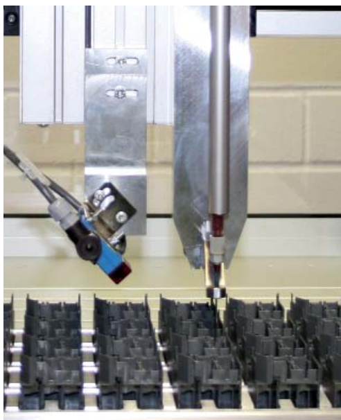
Dispensando en las carcasas de los relés la resina epoxi mezclada
