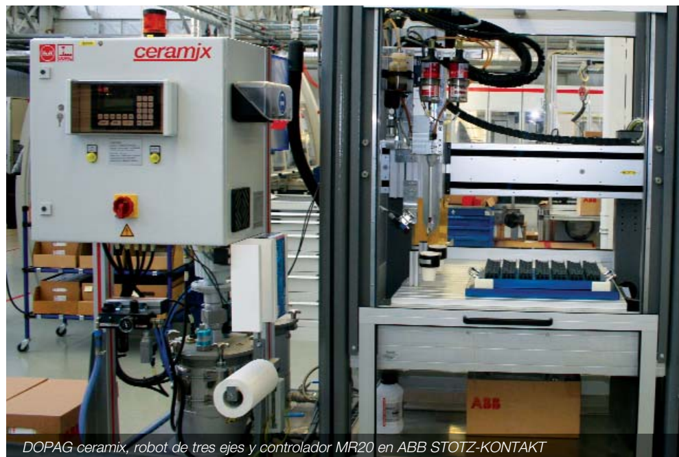
Dispensando en las carcasas de los relés la resina epoxi mezclada
