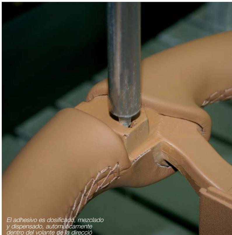
*El adhesivo es dosificado, mezclado y dispensado, automáticamente dentro del volante de la dirección*
