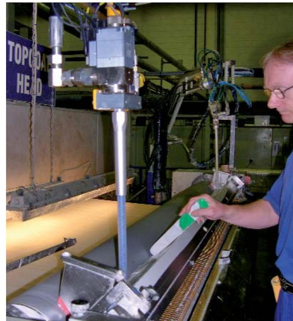
Mezclado y dispensado del recubrimiento de silicona en la malla del tejido
