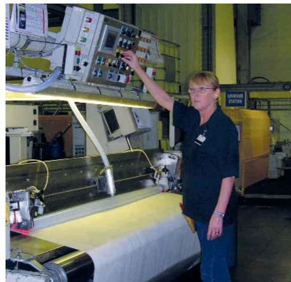
Controlando el caudal de la silicona mezclada sobre el tejido
