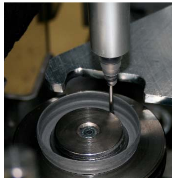
Mezcla de fluoro elastómero FKM aplicada automáticamente dentro de la cavidad de junta
