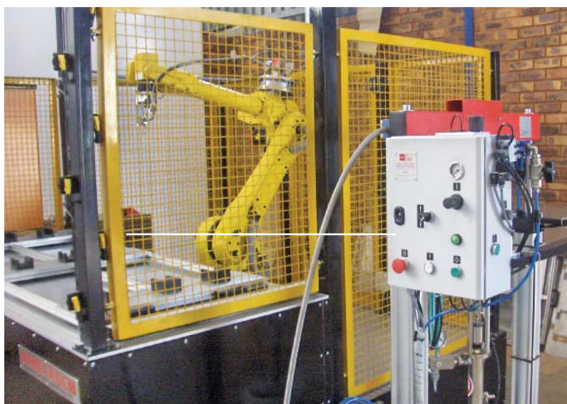
Célula de dispensado coordinando una bomba P200 de DOPAG, válvula de dispensado automático y regulador de presión de material con diafragma montado sobre un robot de 6 ejes
