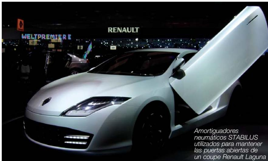
*Amortiguadores neumáticos STABILUS utilizados para mantener las puertas abiertas de un coupe Renault Laguna*
