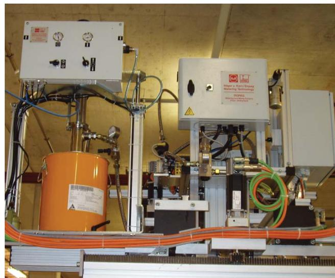
La bomba P30 de DOPAG y las bombas de engranaje montadas en la parte superior, directamente sobre las estaciones del robot
