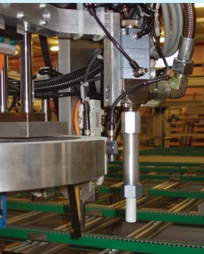
La válvula de dispensa de membrana DOPAG y la boquilla instaladas en el robot, listas para aplicar el sellador
