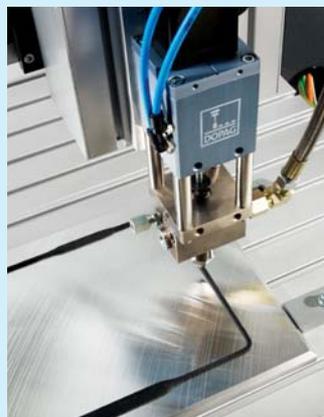
La nueva válvula, diseñada para manejar materiales abrasivos utiliza tecnología motriz lineal acoplada a un amplificador neumático que se comunica con el robot por medio de una señal analógica simple de 0 -10 volts, con lo que se tiene una proporción precisa de flujo controlado, ajustable con exactitud de hasta 1 litro/minuto.
