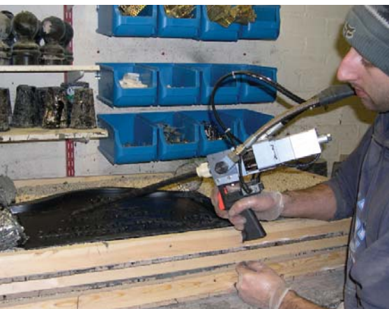
Aplicando mezcla de poliuretano en los moldes
