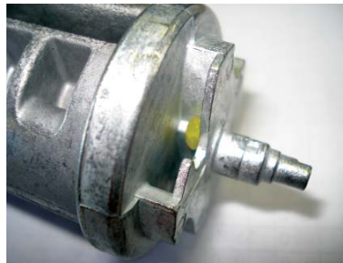
Carrete de un cinturón de seguridad retráctil mostrando el depósito de grasa
