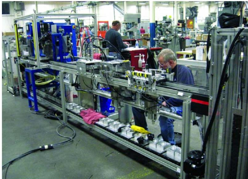
La sección de dispensa de grasa de la línea de ensamblaje en construcción
