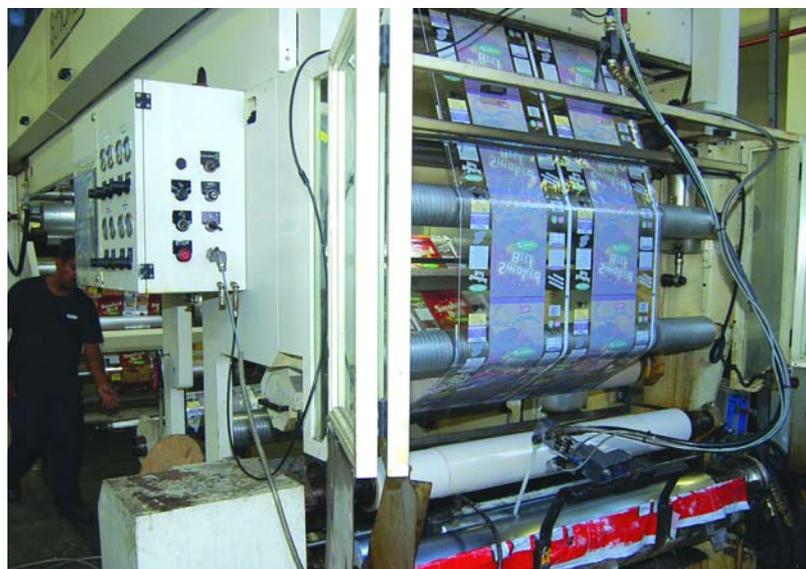
Aplicando la mezcla de adhesivo dentro de la película de laminado
