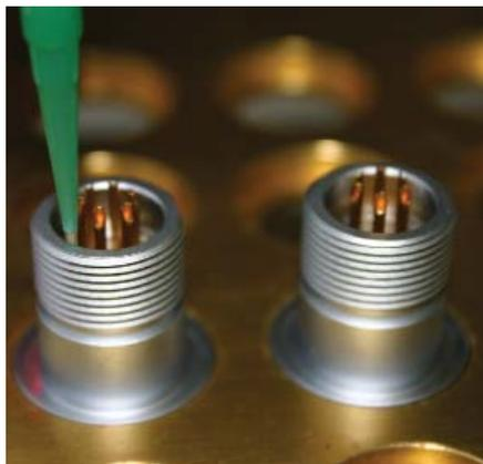
*Dosificando la mezcla de resina en el contactor*
