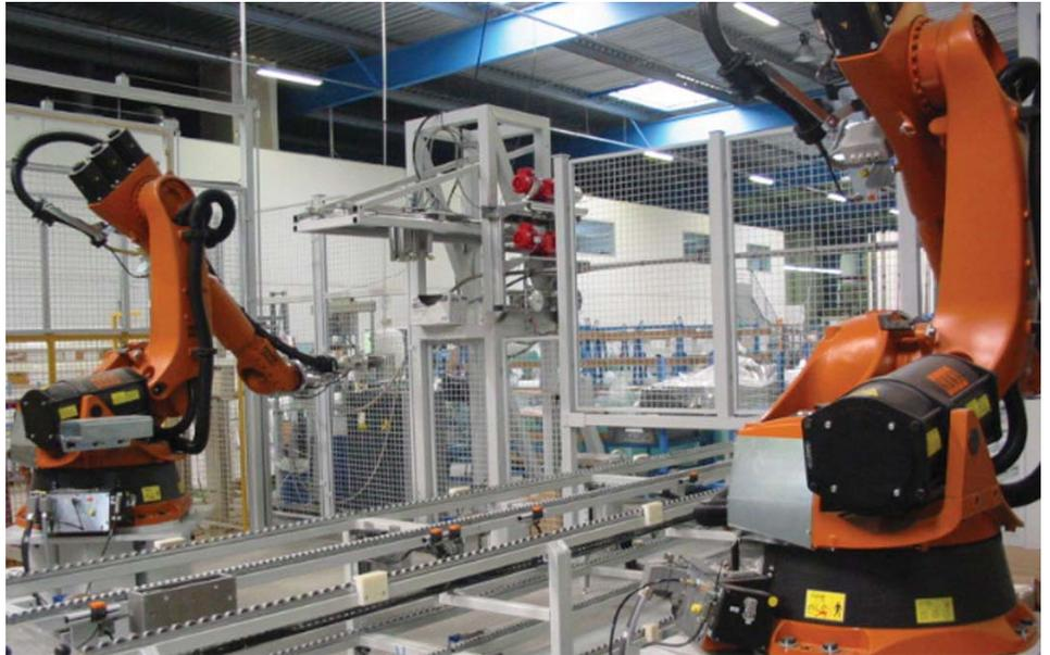
Sistema DOPAG ELDO-MIX (centro) alimentando un robot con una válvula dispensadora (izquierda)
