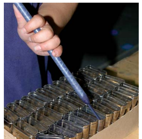
Aplicando la mezcla de resina epóxica dentro de las abrazaderas para las brochas por medio de un mezclador estático de plástico desechable
