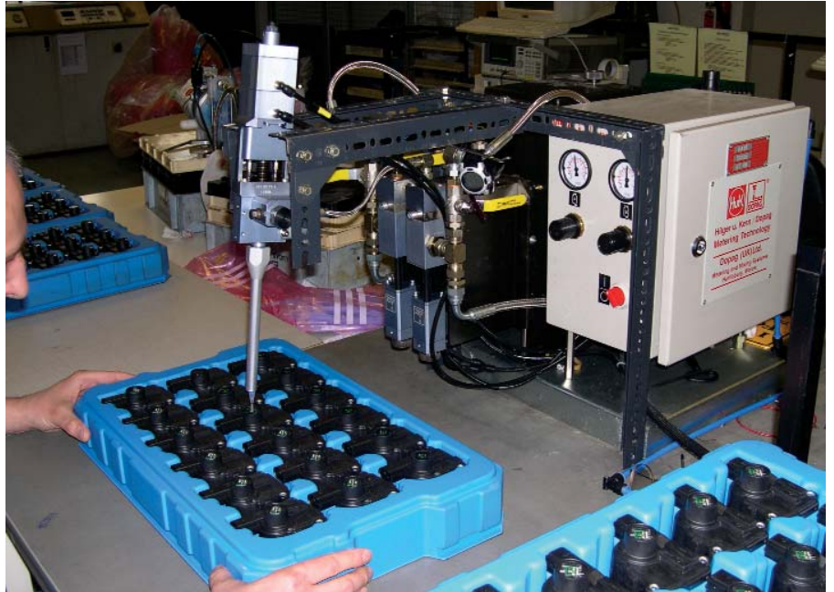
Midiendo y mezclando silicona sobre los circuitos impresos ensamblados
