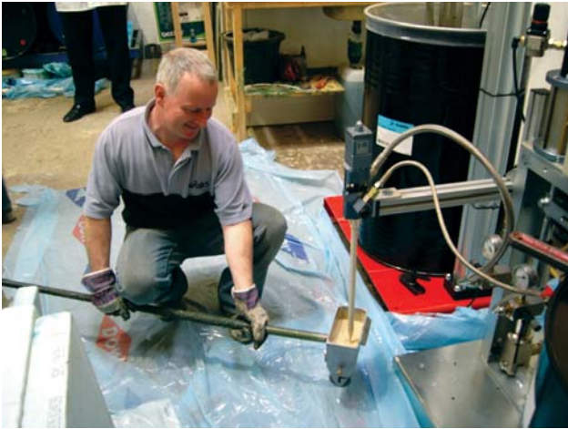
Llenando el rodillo con una mezcla de poliuretano
