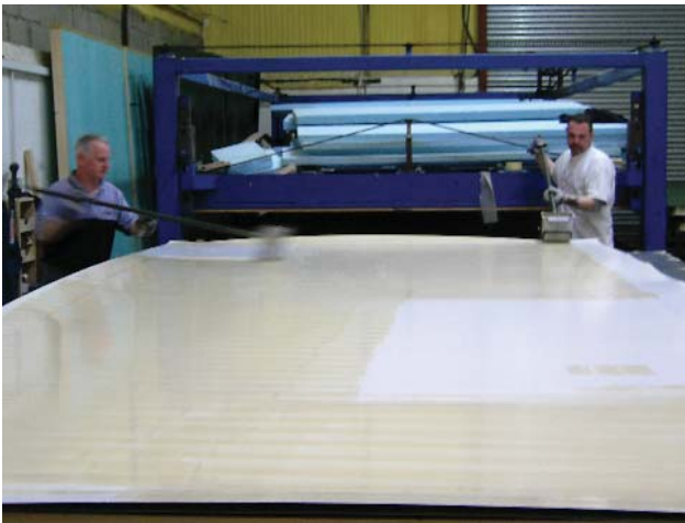
Aplicación de poliuretano sobre el panel
