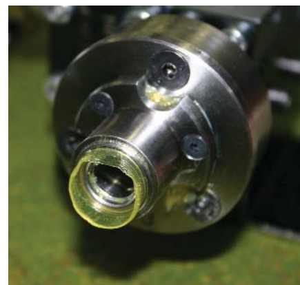
Una vista final de un aplicador, mostrando claramente la dosis medida de grasa que normalmente se inyectaría a un rodamiento
