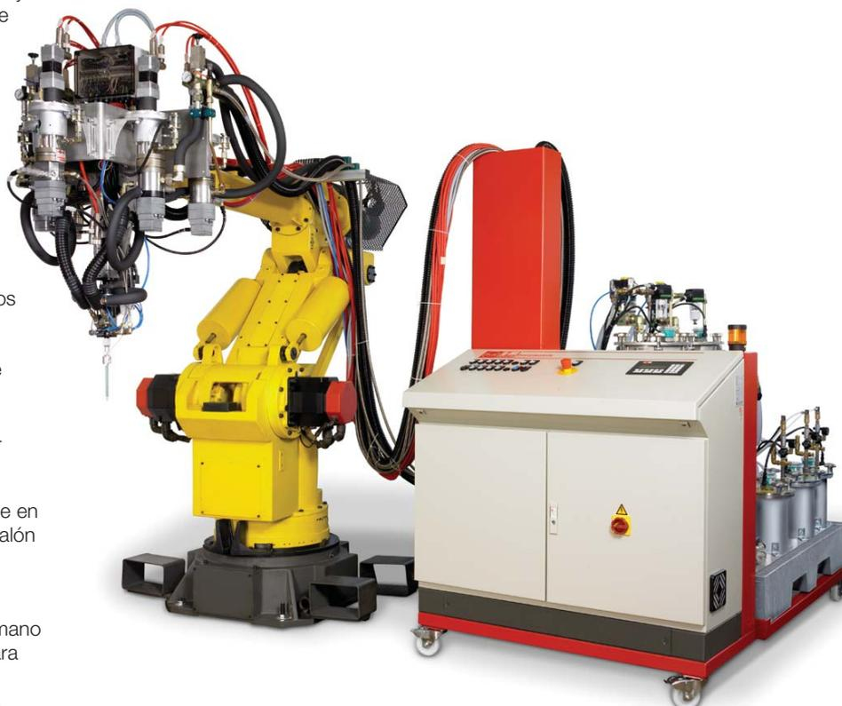
La producción de plantillas es un proceso complejo, completamente automático que implica la integración de tres componentes, además de dos colores por medio de una máquina de medición y mezclado DOPAG ELDO-MIX 603 con un robot de seis ejes. La ELDO-MIX 603 es un sistema de medición y mezclado con engranaje, generalmente empleada para aplicar una sustancia multicomponente como resinas epóxicas, poliuretanos o silicones y es capaz de procesar incluso materiales con mayor o menor viscosidad.
