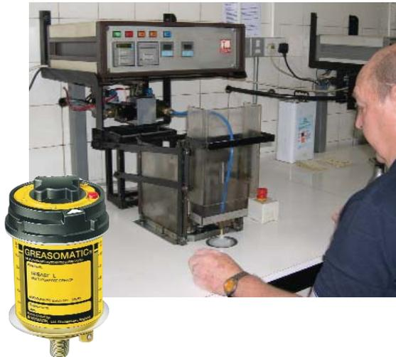
Wymark Ltd. De Cheltenham en Gloucestershire ha usado durante unos 16 años dos sistemas de medición de flujo tipo engranaje para dosificar con exactitud lubricadores "Greasomatic". Los lubricadores están diseñados para inyectar grasa automáticamente dentro de los cojinetes de la máquina por períodos preseleccionados de hasta 12 meses.
