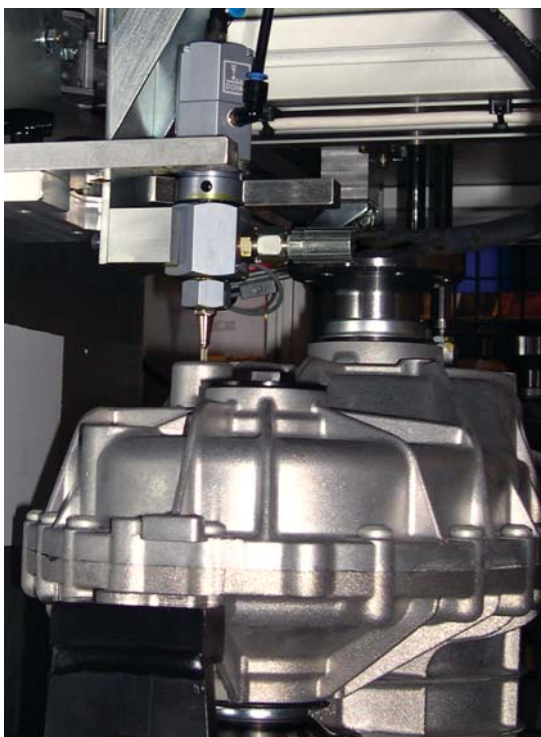
DOPAG "Snuffer" valve rellenando caja de transmisión
