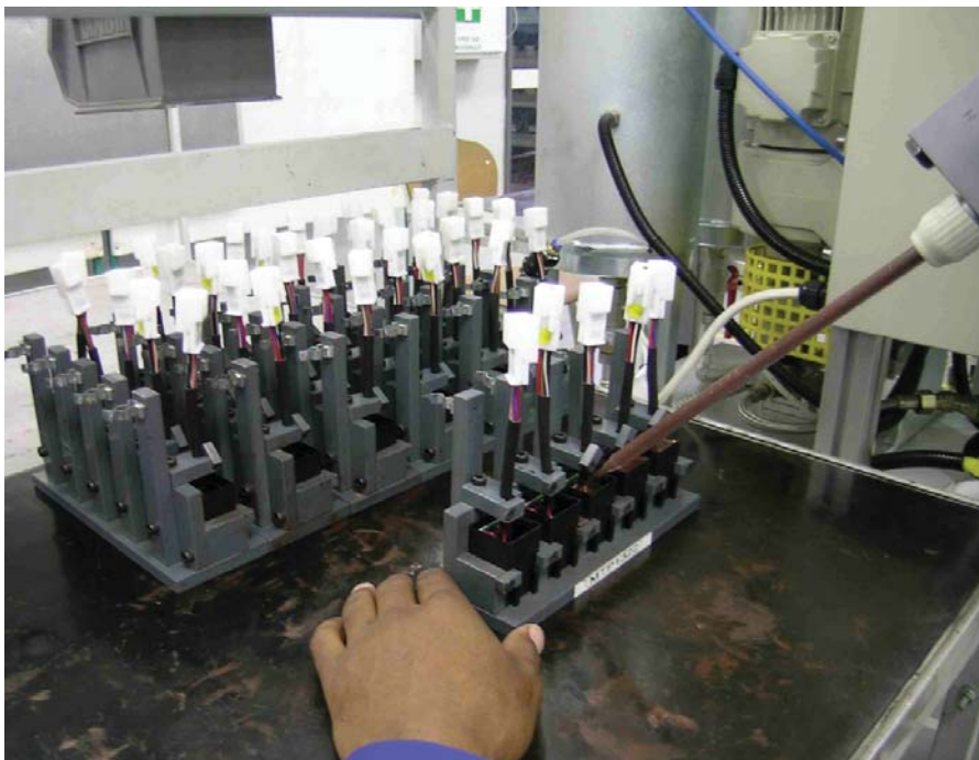
Dispensando poliuretano mezclado
