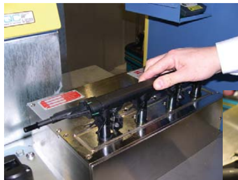
Colocando el rail de carburante en posición
