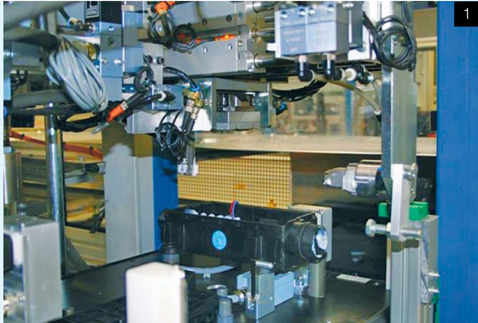
Válvula dosificadora con cámara (arriba a la izquierda) dispensa la grasa vía un adaptador especial al mecanismo de la unidad de freno
