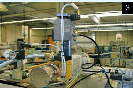
Un contador volumétrico en línea comprueba el caudal de adhesivo
