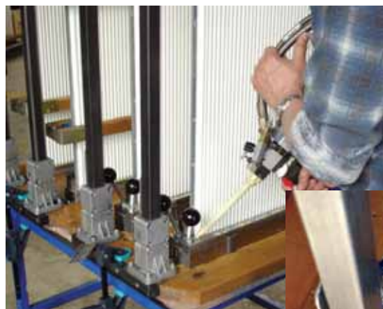
Resina mezclada dispensándose en el molde
