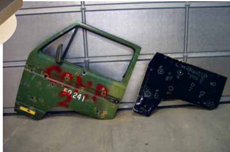
Panel antibalas tras ensayo
